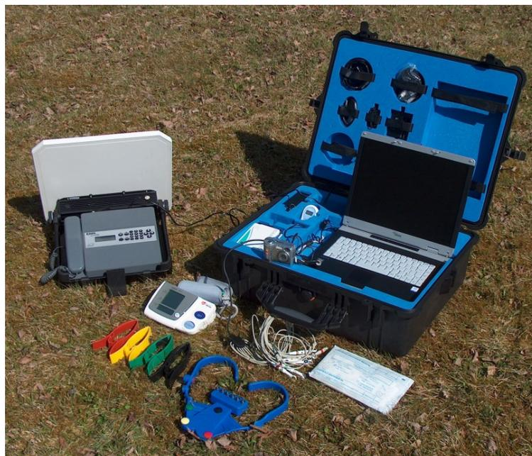
Abbildung 4: Satellitengestütztes, transportables Telemedizinssystem<sup>10</sup>
