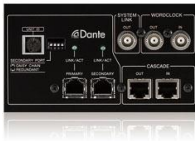
Abbildung 3.6: Dante Port und entsprechende Schnittstelle, Quelle: www.yamaha.de
