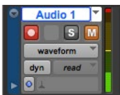
Abb. 39: Ein rotes Viereck über der Pegelanzeige weist auf eine Übersteuerung hin (Clipping). Klicken Sie darauf um die Anzeige zurückzusetzen.
