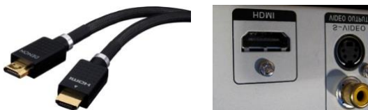
Abb. 3: HDMI-Kabel und -Anschluss: „1-Kabel“-Schnittstelle für multimediale Anwendungen
