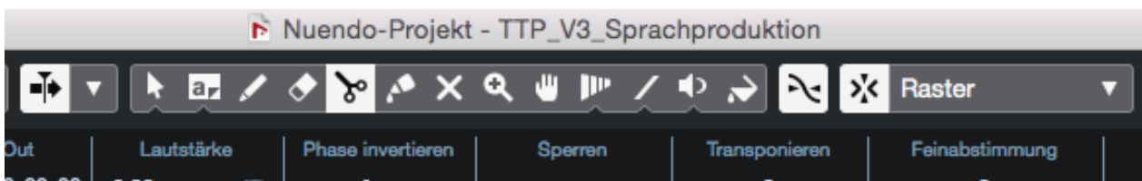
Abb. 46: Die Funktionen im Überblick: Objektauswahl, Auswahlrahmen, Schere (Cut), Kleber, Radierer, Zoom, Stummschalter, etc...
