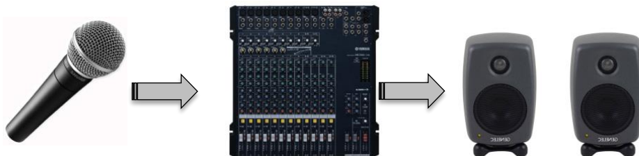
Abb. 26: Skizze des Signalwegs für Aufgabenstellung 2.1.2
