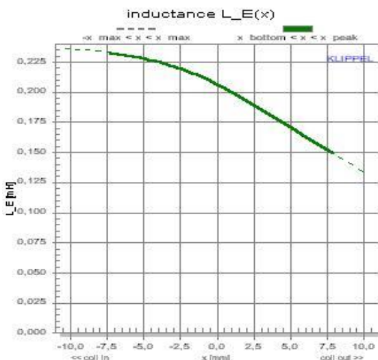
Abb. 20: Induktivität L_E in Abhängigkeit von der Auslenkung x .
