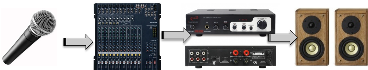
Abb. 31: Skizze des Signalwegs für Aufgabenstellung 2.1.2
